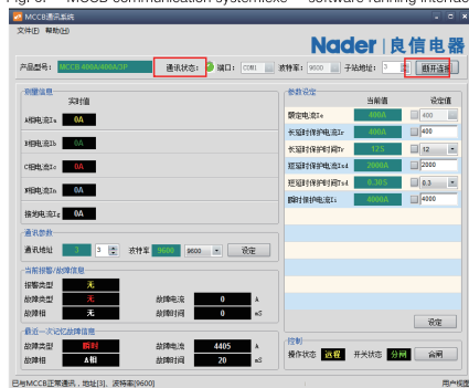
图 7：通讯连接正常界面
